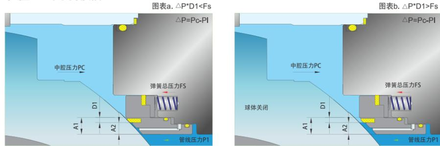
当阀门中腔压力(PC)小于座圈弹簧的预紧力(Fs)和管线流体压力(P1),即 $\Delta P \times D1 < Fs$ ,则球体和阀座紧密接触确保密封。
